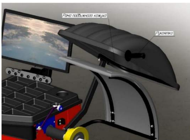
Рис. 8. Крепление рукоятки к раме подвижного кожуха
