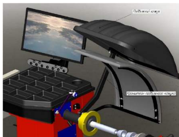
Рис. 7. Установка подвижного кожуха
